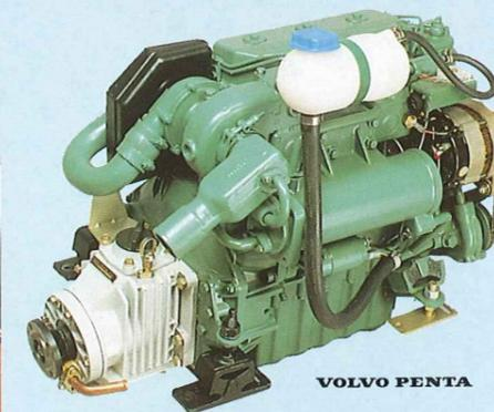
**Ein leistungsstarkes Kraftpaket.** Die Najad 360 ist mit einem Dreizylinder Schiffsdiesel Volvo Penta 2003 Turbo ausgerüstet. Dieser 43 PS (32 KW) starke Antrieb gibt dem Boot eine Geschwindigkeit von etwa 8 Knoten. Zuverlässigkeit bei Dauerleistung und robuste Tech-
